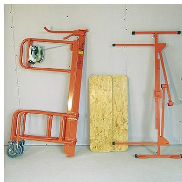
Excellent maintien et bonne protection de la plaque de plâtre quelle que soit sa dimension. Bras télescopiques et repliables pivotant sur 360° avec système de blocage.
